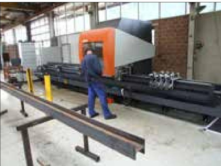
Das SBZ 130 kann im Pendelbetrieb an 2 Stationen arbeiten. Ein Revolverkopf ermöglicht kurze Werkzeugwechselzeiten.
