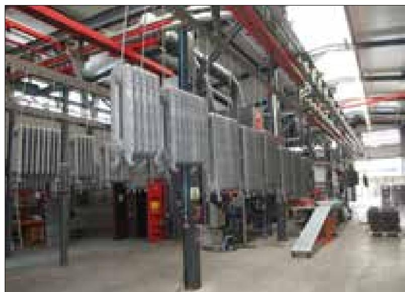
Kienzler verfügt über einen umfangreichen Maschinenpark. Im Bild die Strahlanlage, durch die gerade Heizkörper laufen.
