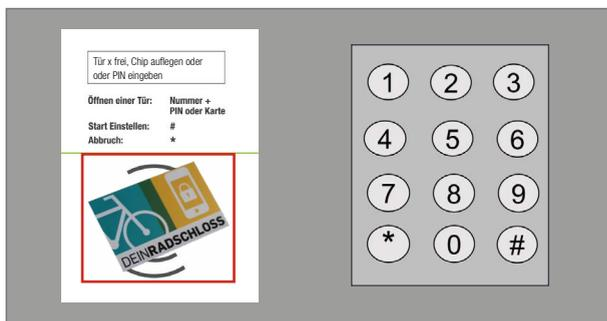
3. Anstatt mit einer PIN, kann die Tür bei Bedarf auch mit einer RFID-Chipkarte geöffnet werden.
